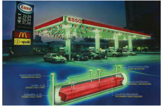
บริษัทฯ ใช้ถังผนัง 2 ชั้น เก็บน้ำมันใต้ดินที่สถานีบริการน้ำมัน เพื่อลดผลกระทบต่อสิ่งแวดล้อม
